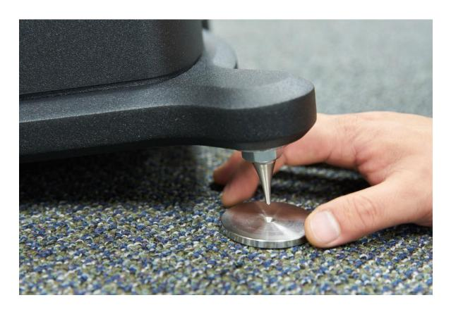
**16.** ADJUST THE SPIKES BY THREADING/UNTHREADING THEM TO LEVEL THE SPEAKER AND TIGHTEN THE LOCK NUT AGAINST THE PUCK TO LOCK THE SPIKE IN POSITION. REPEAT THIS PROCEDURE FOR ALL SPIKES.
